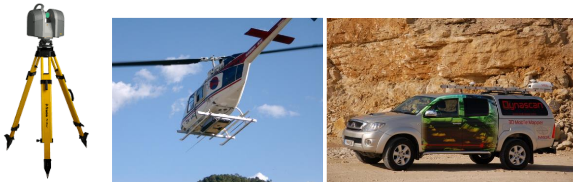
Slika 11. Laserski skener montiran na stativ, helikopter i vozilo u pokretu
